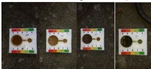
Rysunek 7. Wyniki badania pH gleby kwasomierzem glebowym z płynem Helliga
